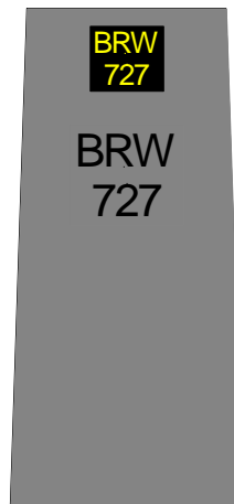
Abb. 10: Nahbereichskennzeichnung anhand inverser Darstellung (zusätzliche Tafel mit kleinerer Schrifthöhe, alternativ darstellbar durch innenbeleuchtete oder angestrahlte Tafeln)
