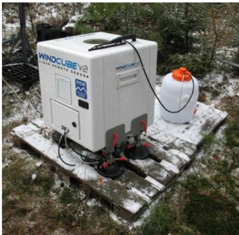
Figure 3: Appareil lidar modèle WindCube V2 de l'institut Fraunhofer IWES Kassel.
