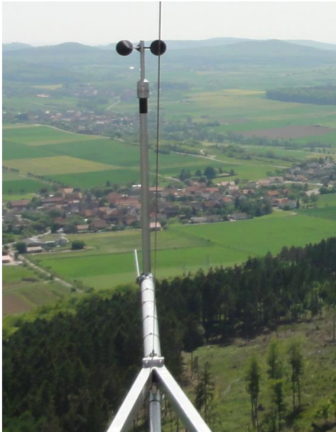
Figure 2: Un anémomètre à coupelles monté sur la console d'un mât de mesure.
