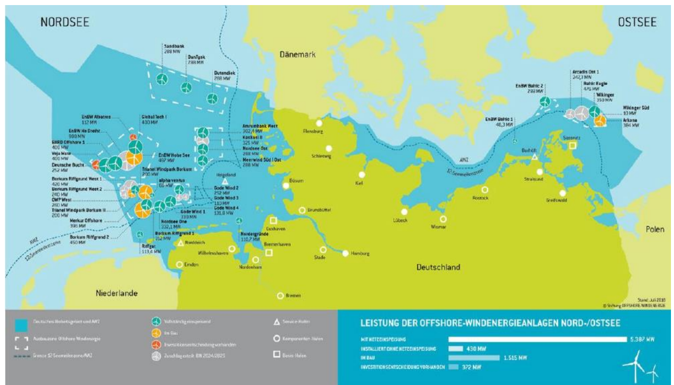
Fig. 2 : Carte des parcs éoliens en mer en Allemagne distinguant entre les parcs avec injection sur le réseau, les parcs installés, en partie en attente de mise en exploitation, les parcs en construction et les projets bénéficiant d'une décision finale d'investissement. 2
