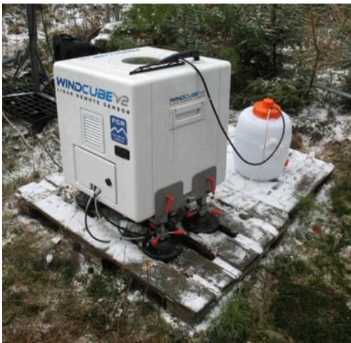
Abbildung 3: LiDAR-Messgerät des Typs WindCube V2 des Fraunhofer IWES Kassel.
