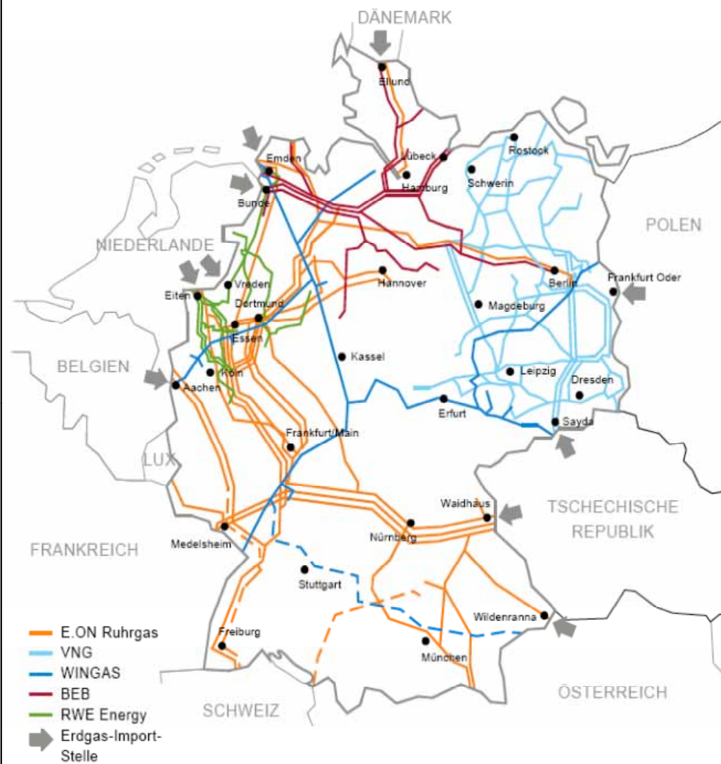
Das Gasfernleitungsnetz in Deutschland
