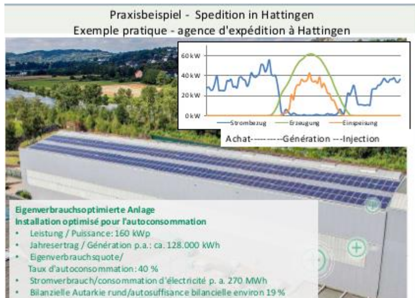
Figure 8 – Volumes d'électricité consommée, produite localement et soutirée du réseau sur la plateforme logistique de Hattingen. On constate que très peu d'électricité est soutirée du réseau en journée car les besoins sont couverts par la production PV. Graphique : AVU
