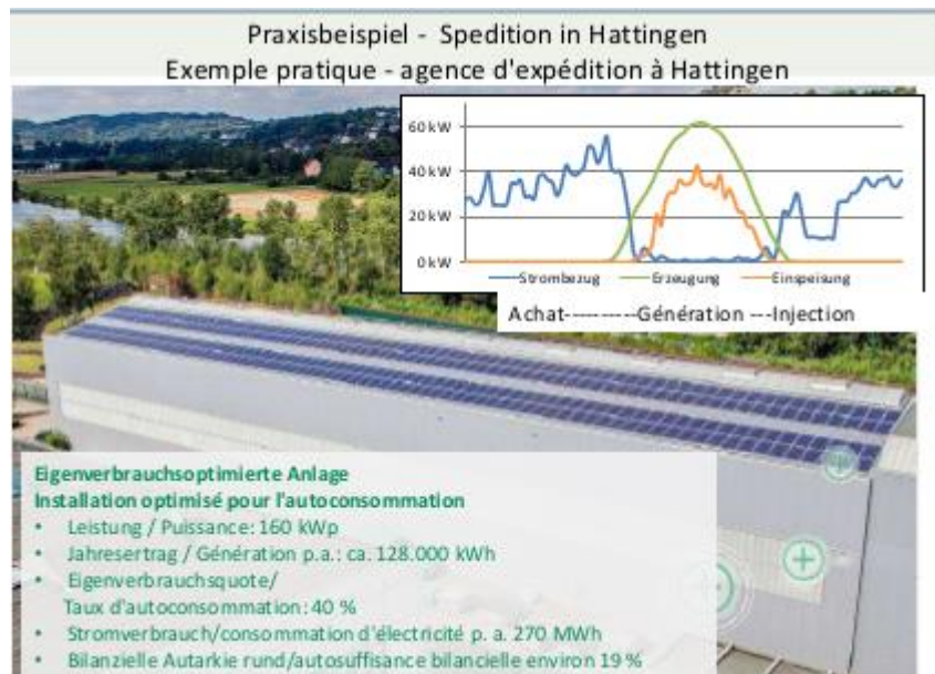
Abbildung 8 – Von der Logistikplattform Hattingen verbrauchte, lokal erzeugte und aus dem Netz entnommene Strommengen. Es ist zu erkennen, dass tagsüber nur sehr wenig Strom aus dem Netz bezogen wird, da der Bedarf durch die PV-Erzeugung gedeckt wird. Grafik: AVU.
